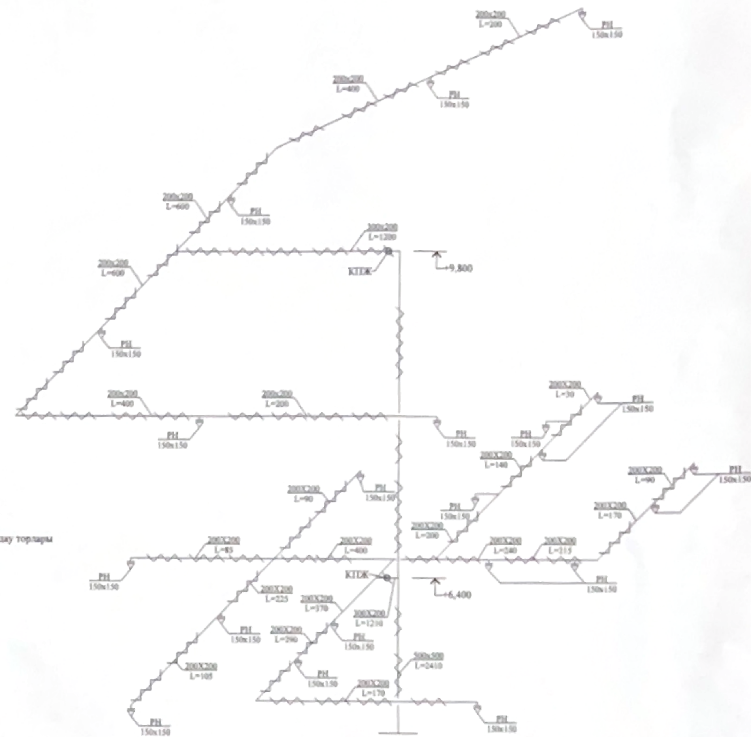
П1 жүйесінің схемасы +3,600 және +7,000 деңгейінде
